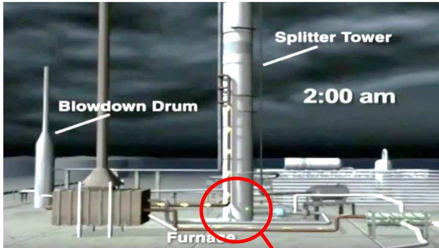
Componentes altamente inflamáveis da gasolina foram alinhados para a Torre de Fracionamento de Refino. A Torre foi preenchida além da capacidade recomendada. Houve falhas em indicadores de nível e alarmes - **Falha na Barreira de Alarmes Críticos e Intervenção Humana.**
